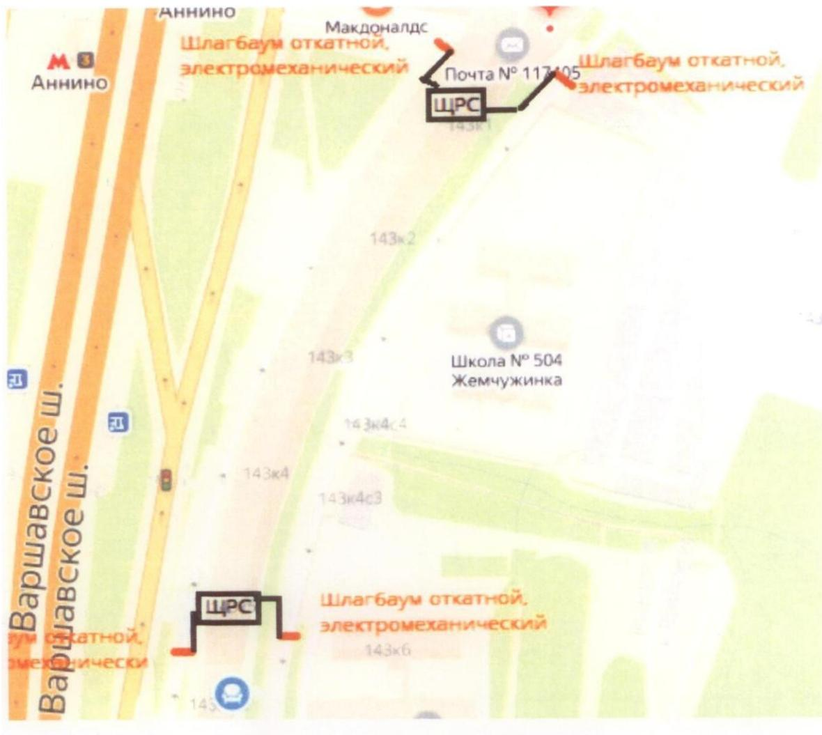
Тип ограждающего устройства: шлагбаум автоматический, откатной с электромеханическим приводом NICE RB 400 – 4 штуки.
